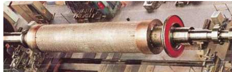
Rotor cilíndrico (liso) que normalmente se emplean en centrales térmicas. Se trata de máquinas de velocidad elevada (1500-3000rpm), por lo que se denominan turboalternadores. Se trata de máquinas de 2 o 4 polos.
